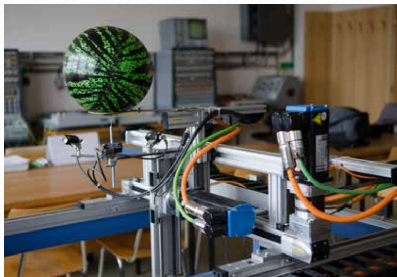
Robotický lachtan – portálový robot, který umí balancovat míč na jehle.
