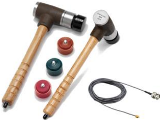
Fig. 14 - Modal sledge hammer: Type 8206-003
