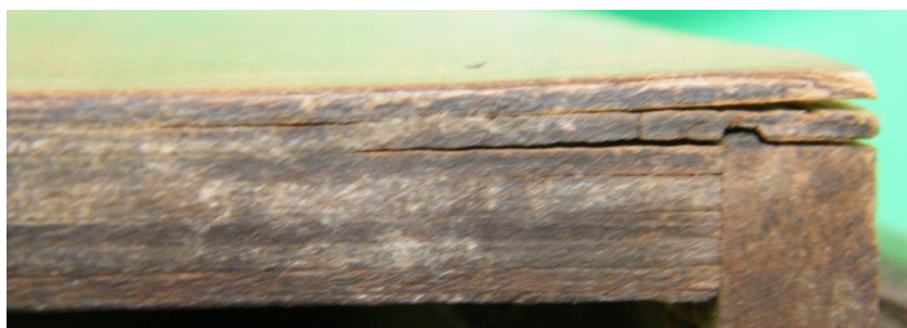
Obr. 3 Detail rozlepenia skrinky (foto: autor)
