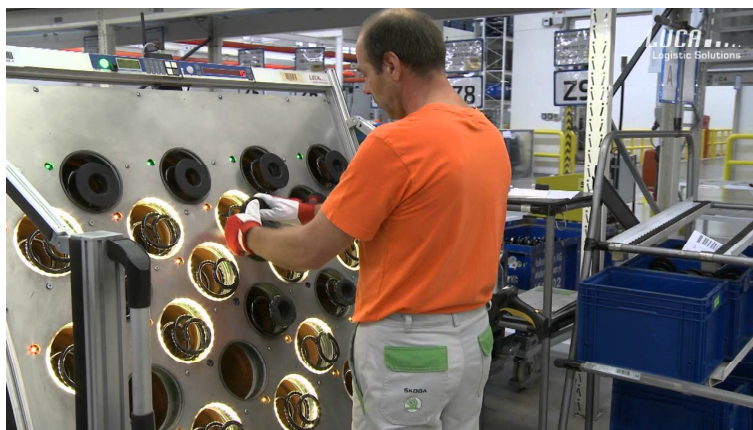
Obr. 1 Příklad plnění sekvenčního regálu [3]
