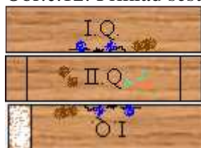
Obr.č.12: Příklad sestavení lamel do hranolu.
