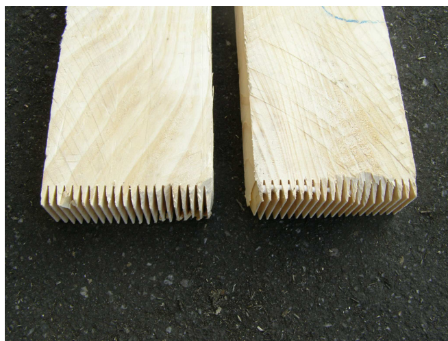
Obr.č.16: Chyba cinkovaného spoje – rozštípané kraje
