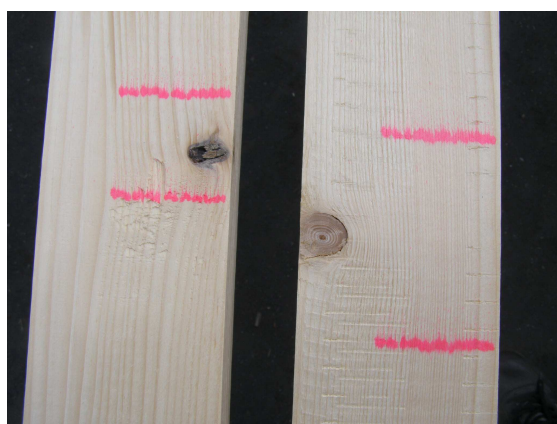
Obr.č.20: Odřezávání vadné části lamely
