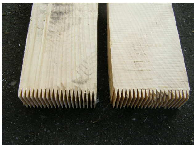
Obr.č.17: Chyba cinkovaného spoje – vyštípané špičky
