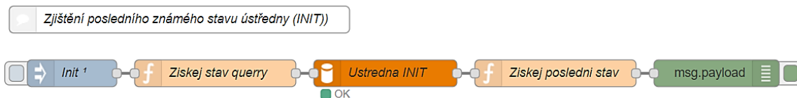
Obrázek 23: Node-RED inicializační sekvence stavu ústředny
