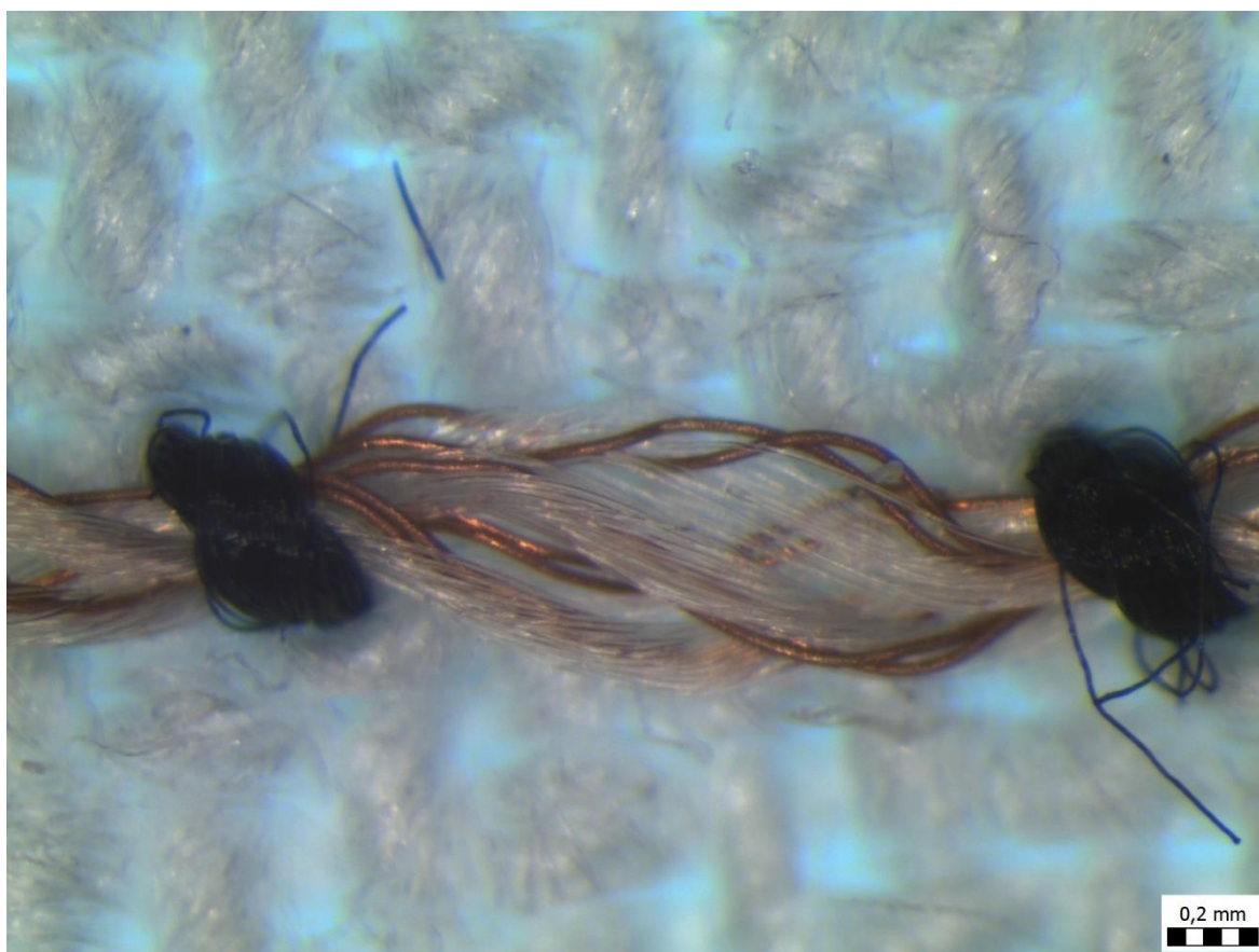
Obr. 17: Detail nitě 25A po deseti cyklech namáčení v potu
