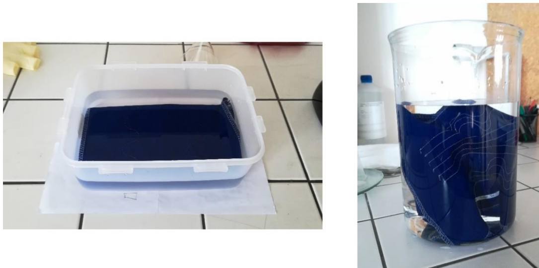
Obr. 16: Průběh testování s potem (vlevo máčení v potu, vpravo proplach vodou)
