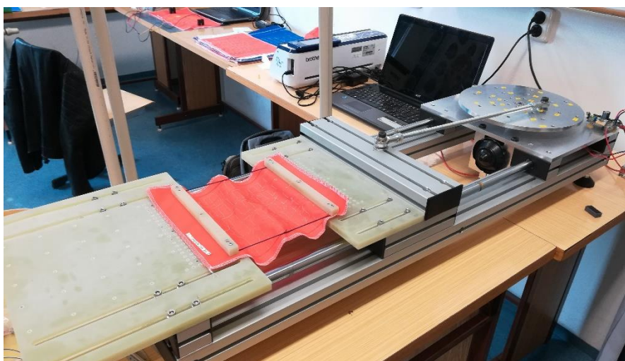
Obr. 6: Bend tester s upnutým vzorkem látky
