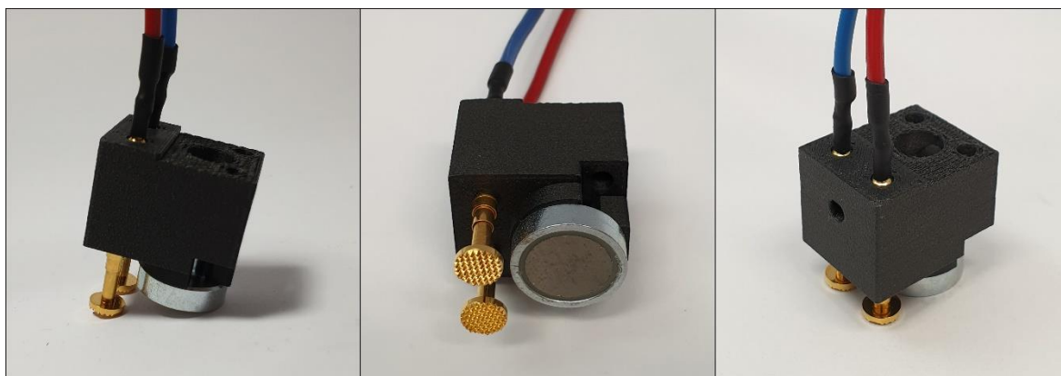
Obr. 21 Sondy použité pro měření přechodového odporu.
