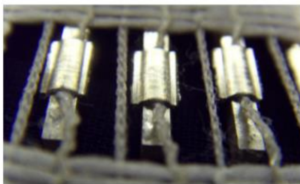
Obrázek 3.6 - Krimpování na textili (převzato z [115])
