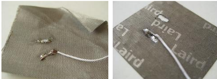
Obrázek 3.5 - Ukázka pájené vodivé tkaniny (převzato z [110])
