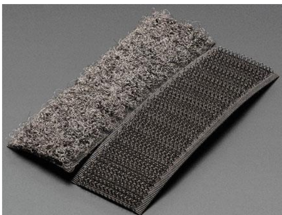
Obrázek 3.8 - Vodivý suchý zip pokovený stříbrem (převzato z [119])
