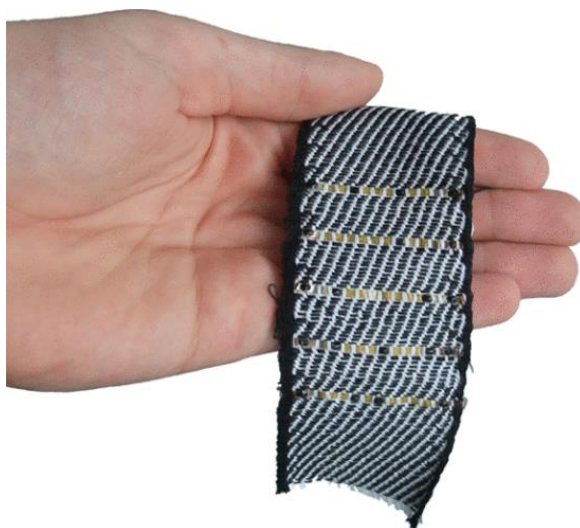
Obrázek 2.7 Textilie s integrovanými plastovými pružnými pruhy obsahující teplotní snímače (převzato z [58])
