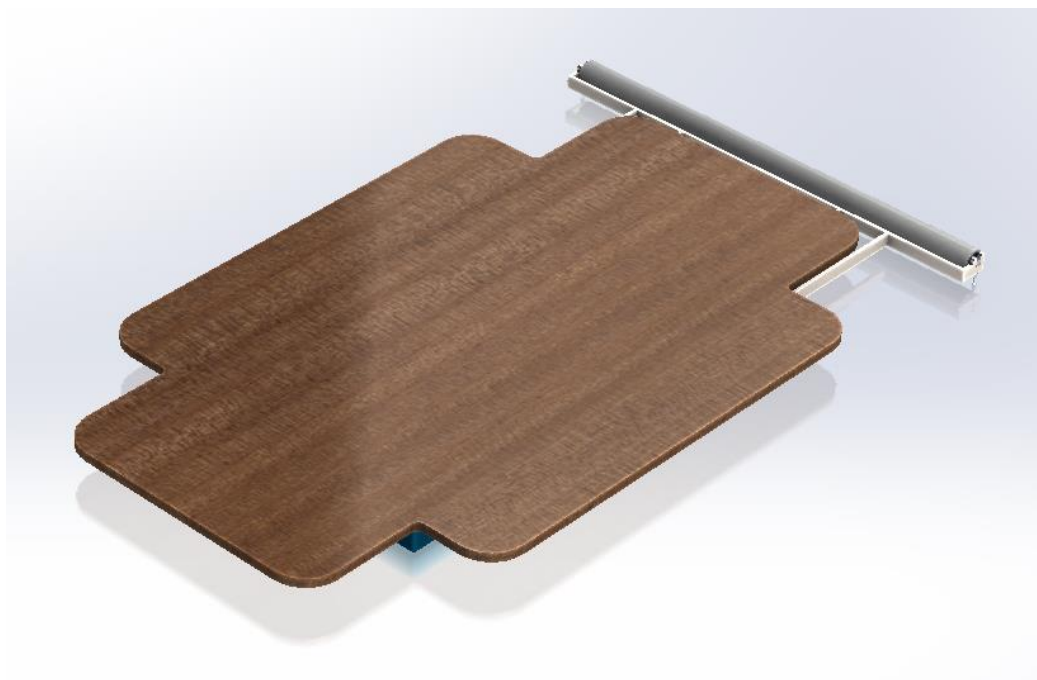
Obr. 8.2 - Návrh polohovatelného stolu pro montáž skříně
