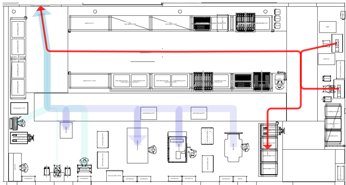
Obr. 10.6 - Tok materiálu výrobku ASK 200, pouze pro operace vrtání - nový stav
