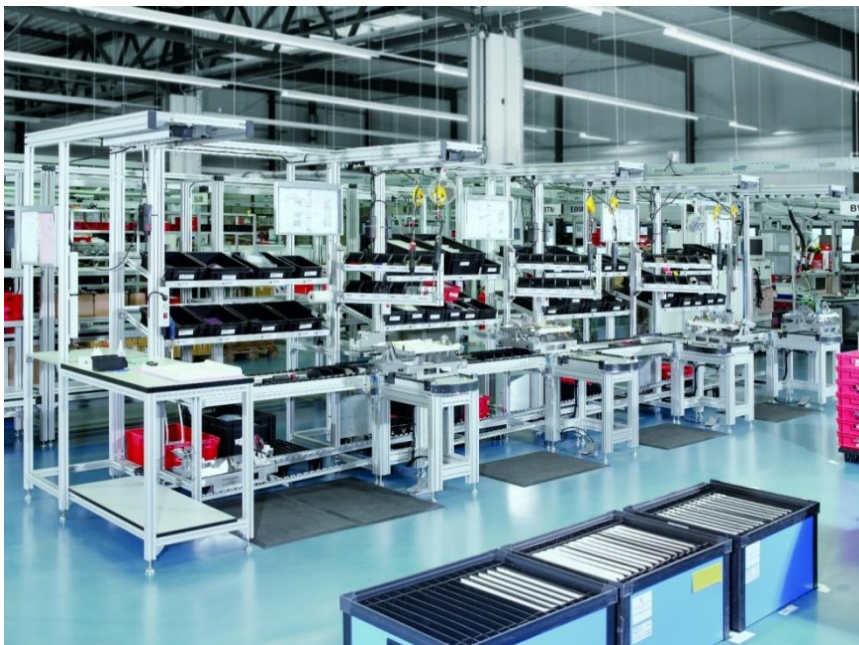
Obr. 4.2 - Montážní linka se spádovými regály [14]
