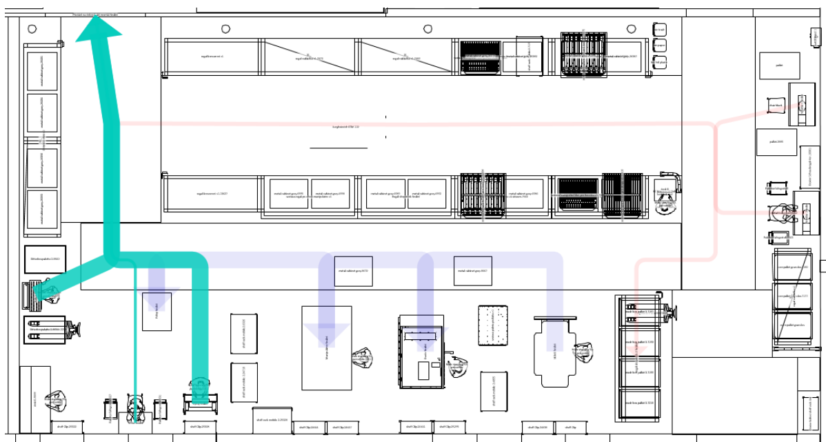
Obr. 10.5 - Tok materiálu výrobku ASK 200, pouze nenavazující operace - nový stav
