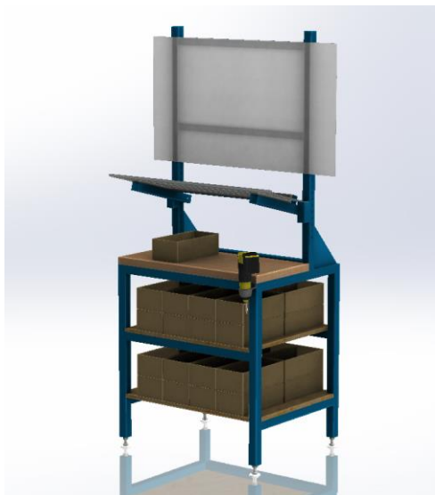
Obr. 8.13 - Návrh polohovatelného stolu pro montáž polic
