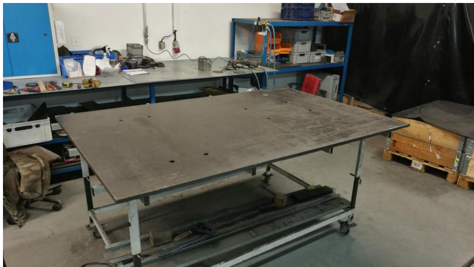
Obr. 7.11 - Pracoviště pro montáž skříně a navařování svorníků
