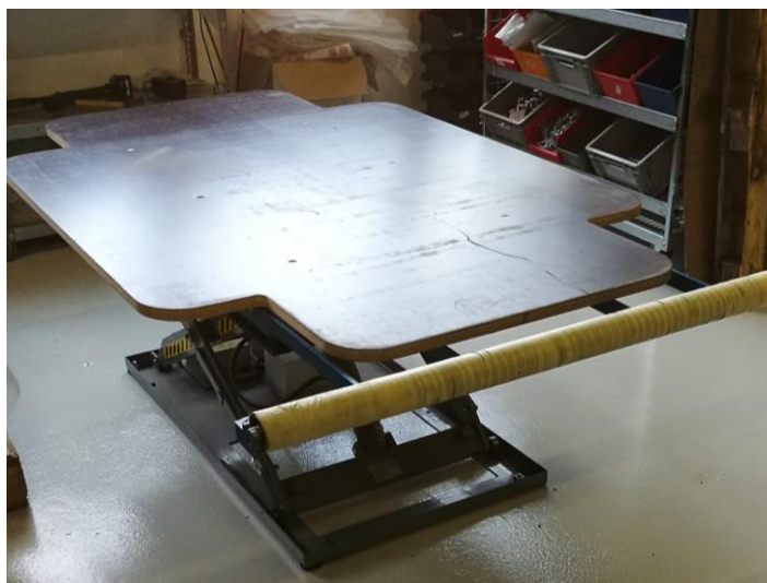
Obr. 11.1 - Realizované pracoviště pro montáž skříní
