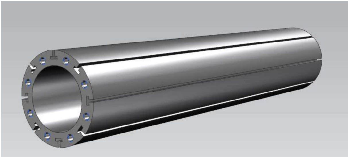
Obrázek 23 - Pohled na drážky pro lopatky v hřídeli
