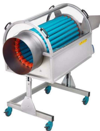
Obrázek 3 - Bubnový separátor vtoků (otloukácí) [1]
