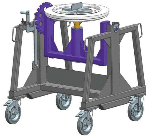
Obrázek 29 - Iso pohled na manipulační stůl s křížovými ložisky
