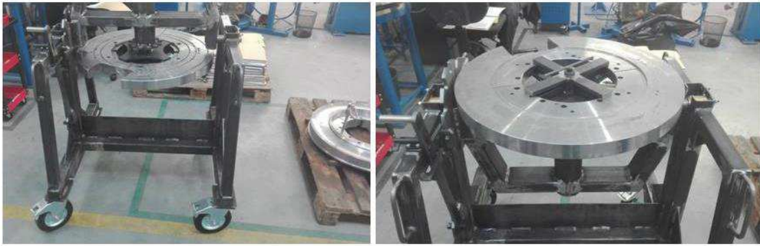
Obrázek 50 - Manipulační stůl s bočnicí ve výrobním procesu
