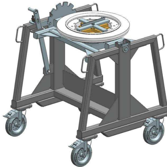
Obrázek 26 - Iso pohled na manipulační stůl s křížovým ložiskem
