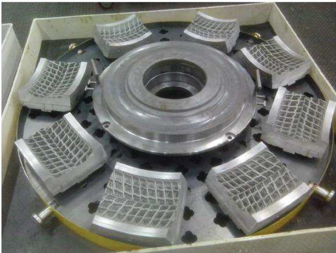
Obrázek 6 - Forma se segmenty [2]
