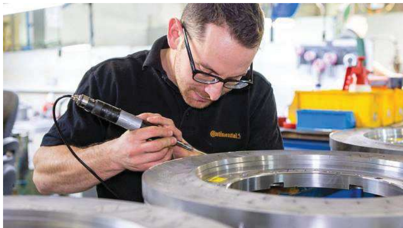
Obrázek 10 - Ruční opracování bočnic [6]
