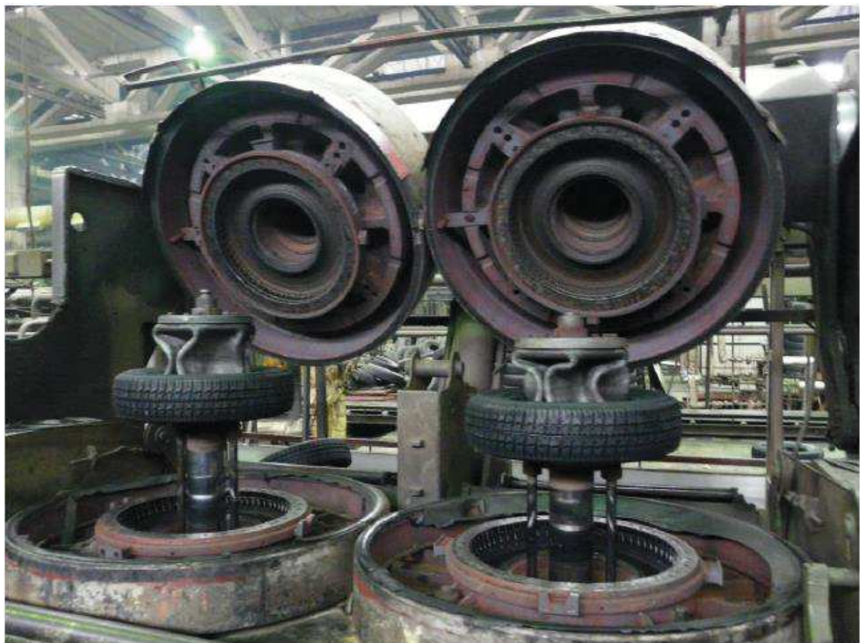
Obrázek 3 - Dvoudílná vulkanizační forma [2]
