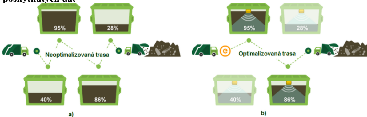
Obrázek 2 - a) Trasa bez informací o zaplněnosti; b) Optimalizovaná trasa na základě poskytnutých dat
