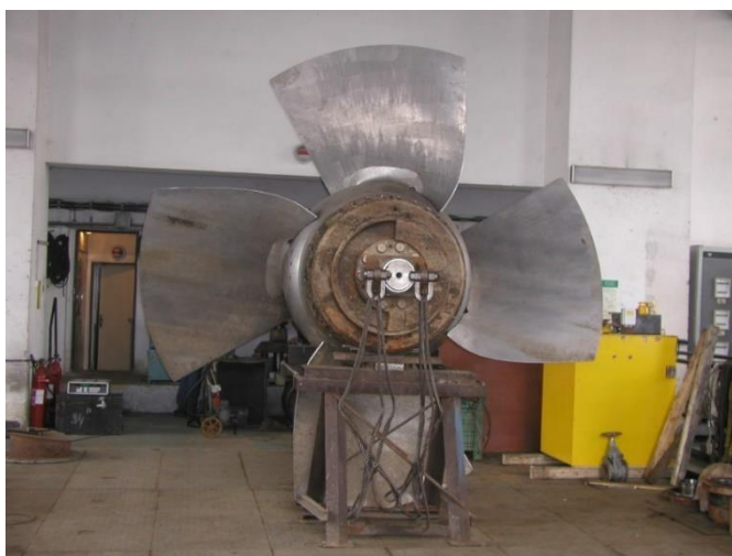
Obrázek 3.4 Demontovaná Kaplanova turbína (MVE Štvanice)
