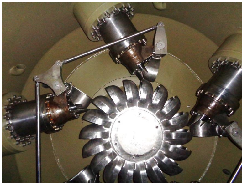
Obrázek 3.1 Detailní pohled na Peltonovu turbínu
