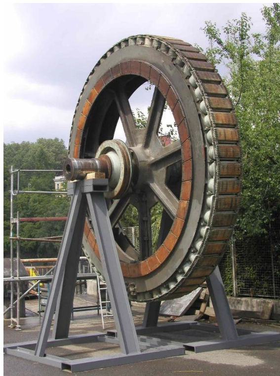
Obrázek 4.1 Demontovaný rotor hydroalternátoru (MVE Štvanice)
