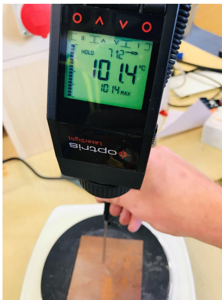
Obrázek 4: Měření emisivity měděné vsázky
