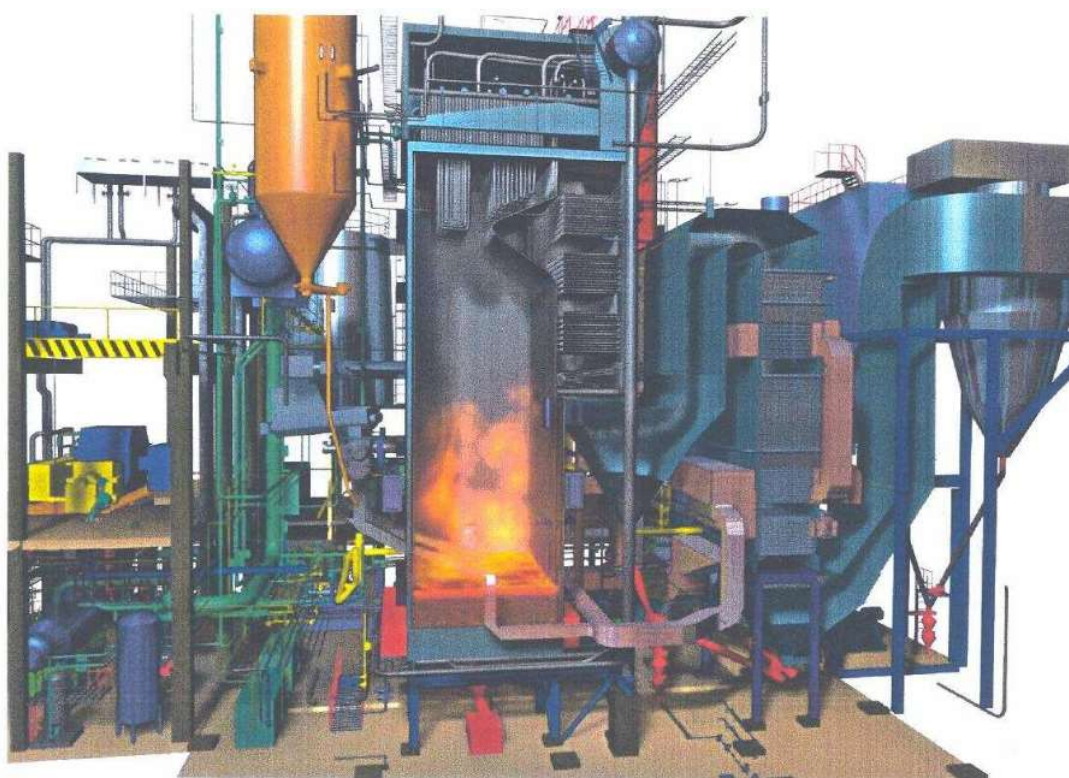
Obrázek 2.5 Schéma fluidního kotle na biomasu [3]
