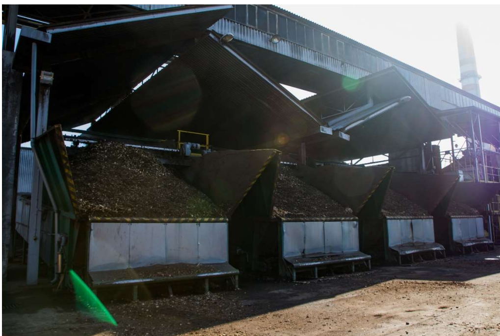
Obrázek 4.4 Násypná část sušky biomasy označené číslem 2
