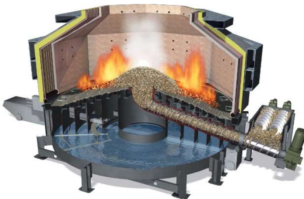
Obrázek 2.2 Spalovací zařízení Biopower s podsuvným přívodem paliva [18]
