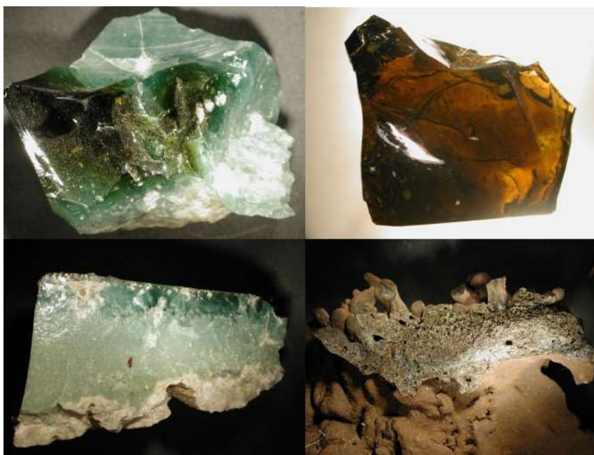
Obrázek 2.6 Snímky skelných (nahore) a skelně krystalických (dole) vrstev vzniklých v plamencové části kotle při spalování pšeničné slámy (vlevo nahore), ječné slámy (vpravo nahore), směsi pšeničné a řepkové slámy (vlevo dole) nebo hnědé dřevní štěpky z borového klestí [22]
