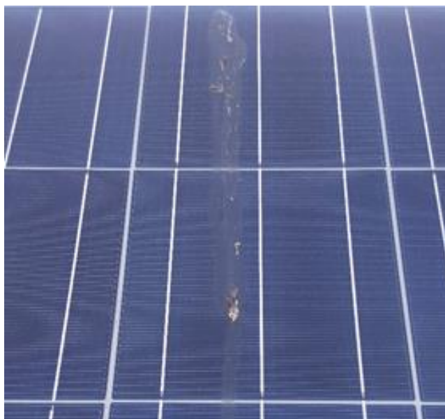
Obr. 2.12 Ptačí exkrementy zakrývající FV články (FVE-S)
