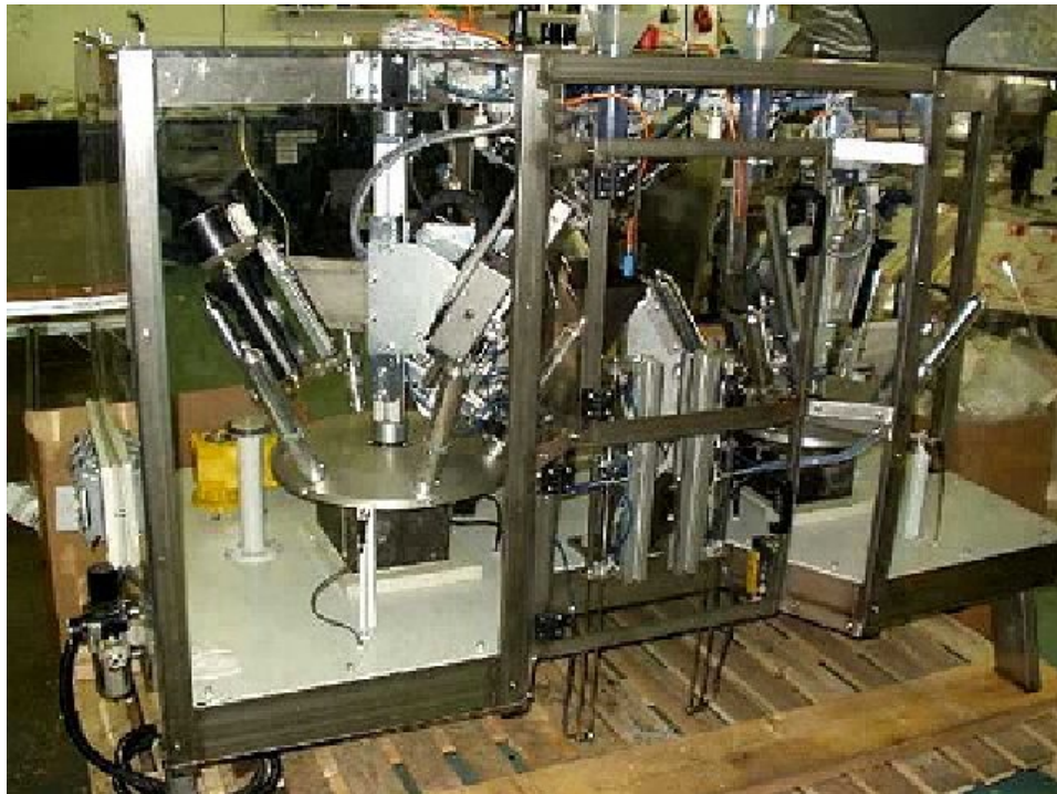
Obr.č. 29 : Příklad na testování kondomů elektrickým výbojem
