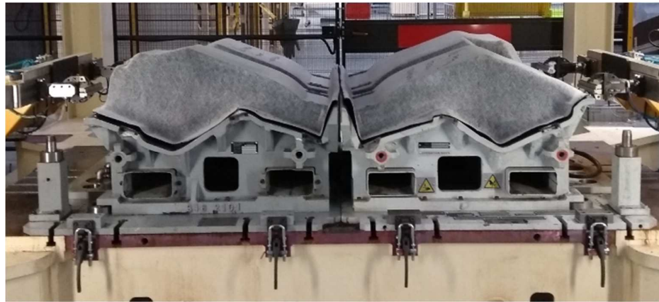
Obrázek 6-6 Tvarovací nástroje uvnitř stroje [vlastní zpracování]
