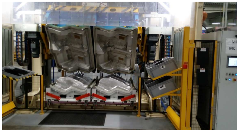
Obrázek 6-8 Pěnovací proces – uložení nástrojů [vlastní zpracování]
