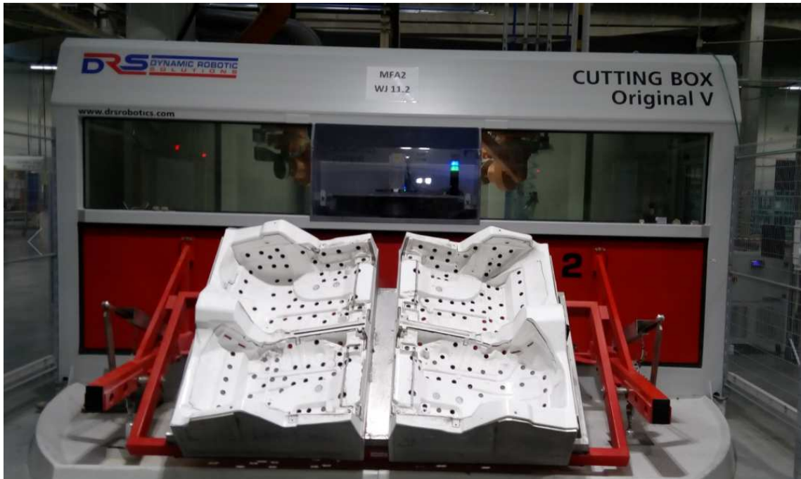
Obrázek 6-9 Proces řezání vodním paprskem – uložení nástrojů [vlastní zpracování]
