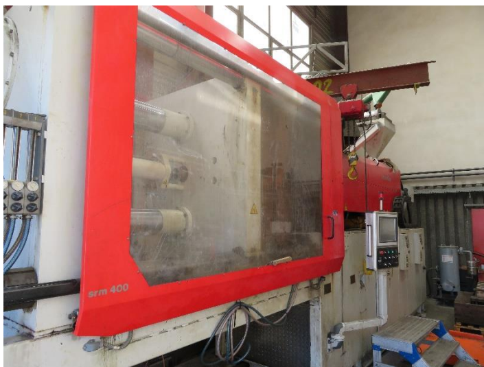
Obr. č. 15: Vstřikovací výrobní linka s vertikálně umístěnou formou
