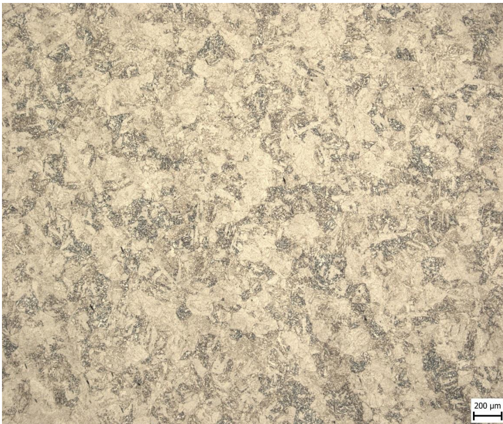
Obrázek 16 Snímek struktury oceli 15CH2NMFA, zvětšeno 50x, leptáno Nitalem
