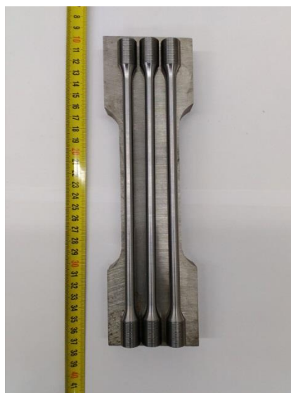
Obrázek 23 Ukázka rozřezu plochých těles, z nichž byly vyrobeny dlouhé tyče (materiál 15CH2NMFA)
