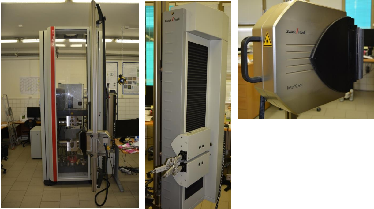
Obrázek 19 a) Univerzální trhačí stroj Zwick Roell Z250; b) mechanické extensometr Zwick Roell MultXtens.PAC2; c) optický extensometr LaserXtens HP
