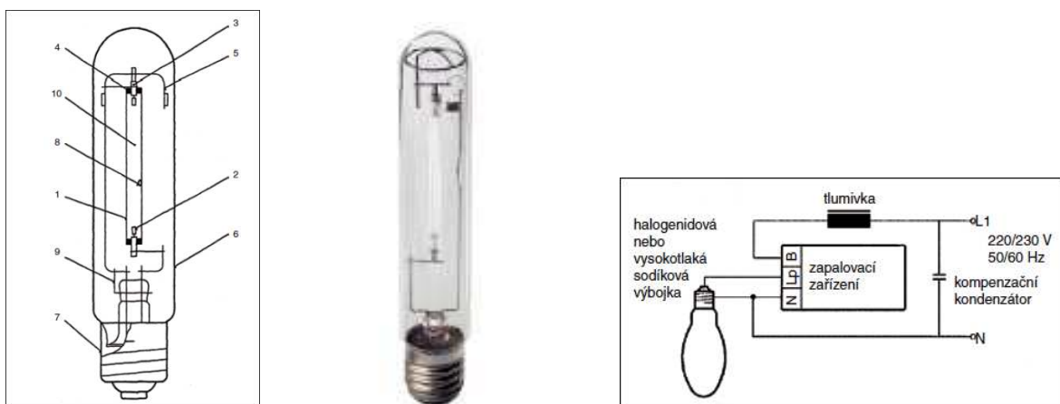
Obr. 7.1: Vlevo je naznačená konstrukce VSV: 1 - hořák, 2 - elektroda, 3 - niobová průchodka, 4 - pájecí kroužek, 5 - nosný rámeček, 6 - vnější baňka, 7 - patice, 8 - amalgám sodíku, 9 – getr, 10 - plynná náplň; Uprostřed – provedení VSV s válcovou čirou baňkou; Vpravo – zapojení VSV. Obrázky jsou převzaty ze zdrojů [8] a [14].
