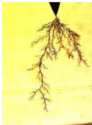
Obr.1: ( Electrical treeing ) Elektrický stromeček při působení vysokého napětí na elektroizolační materiál. Převzato z: [3].
