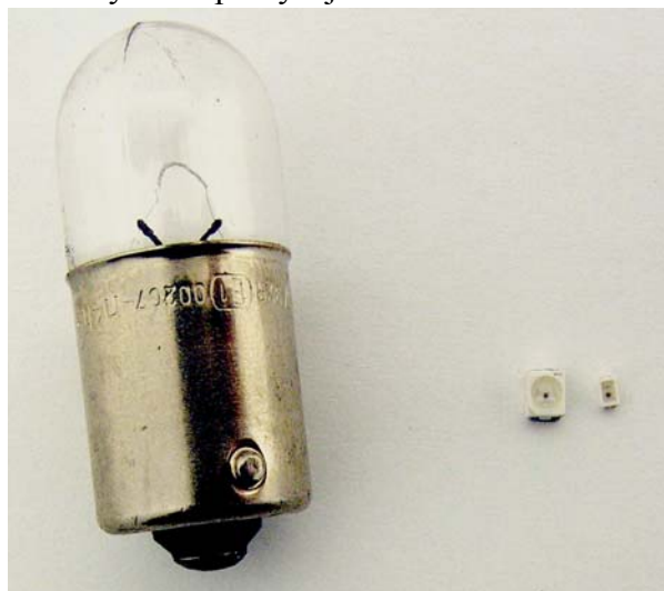
Obr. 13 Velikost LED diod v pouzdře pro povrchovou montáž oproti 5 W žárovce
