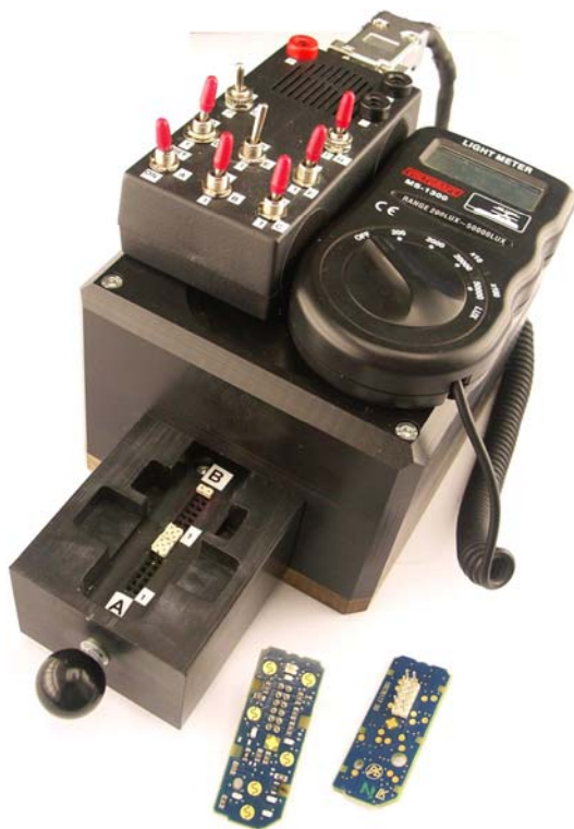
Obr. 34 Zkušební přípravek k ověření svítivosti diod
