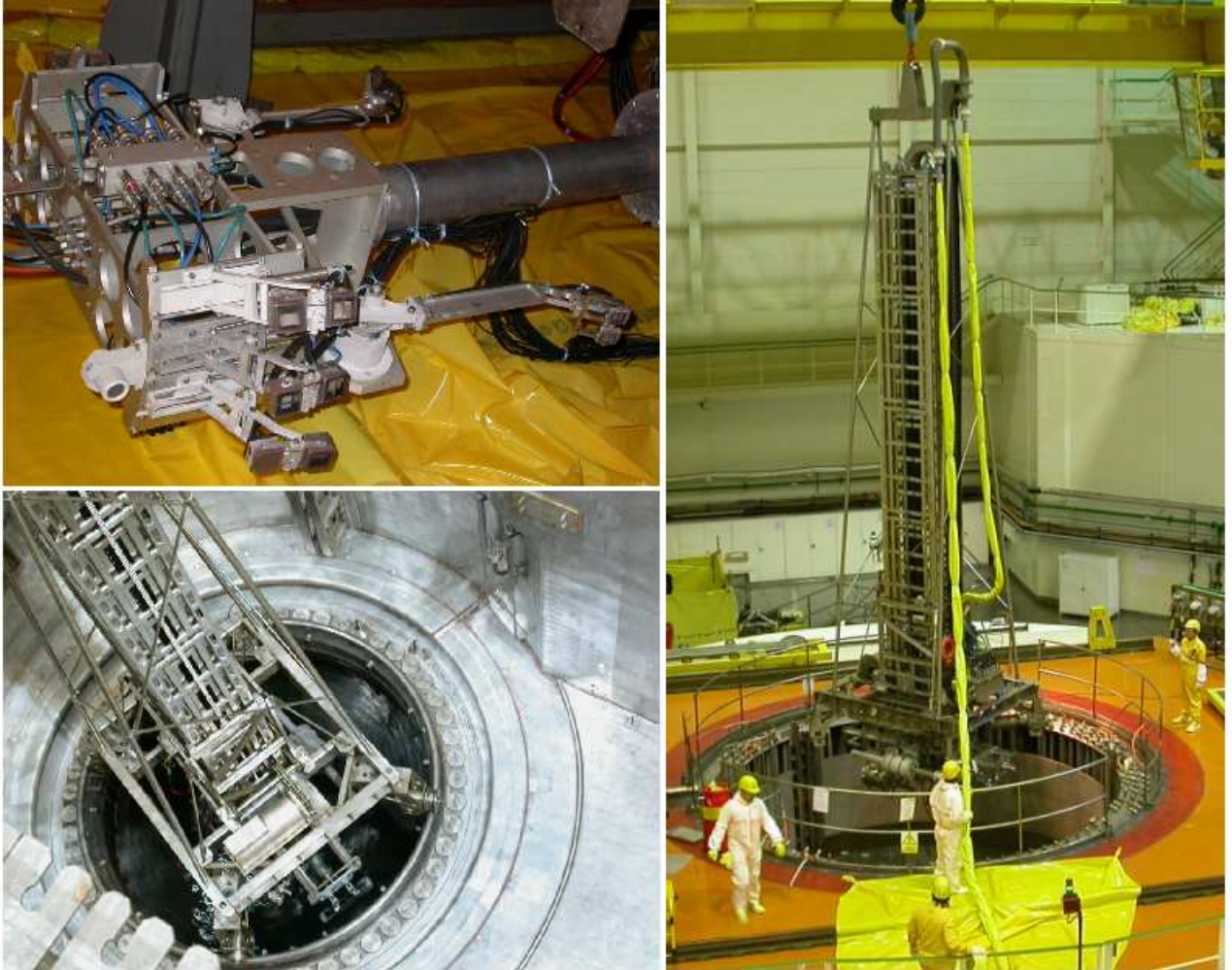
Obr. 3.3 Vlevo nahoře detail ramene se sondami, vlevo dole usazený manipulátor SKIN na přírubě reaktoru VVER 1000, vpravo manipulátor SKIN při zavážení do reaktorové šachty VVER 440
