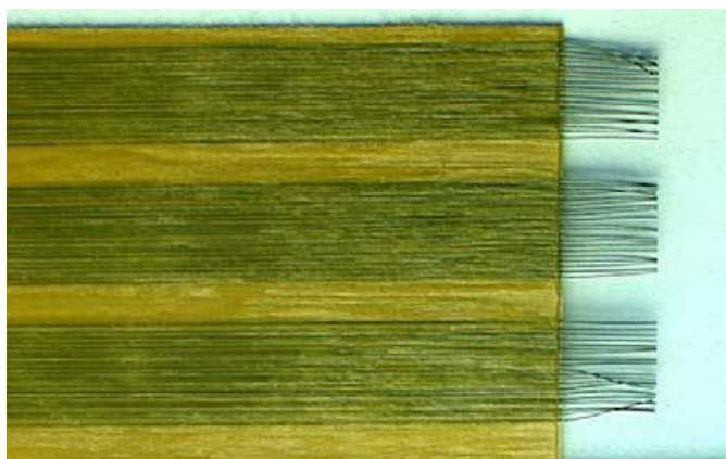
Obr. 27: NiTi drátky zabudované do vyztužených desek z epoxidové pryskyřice [251].
