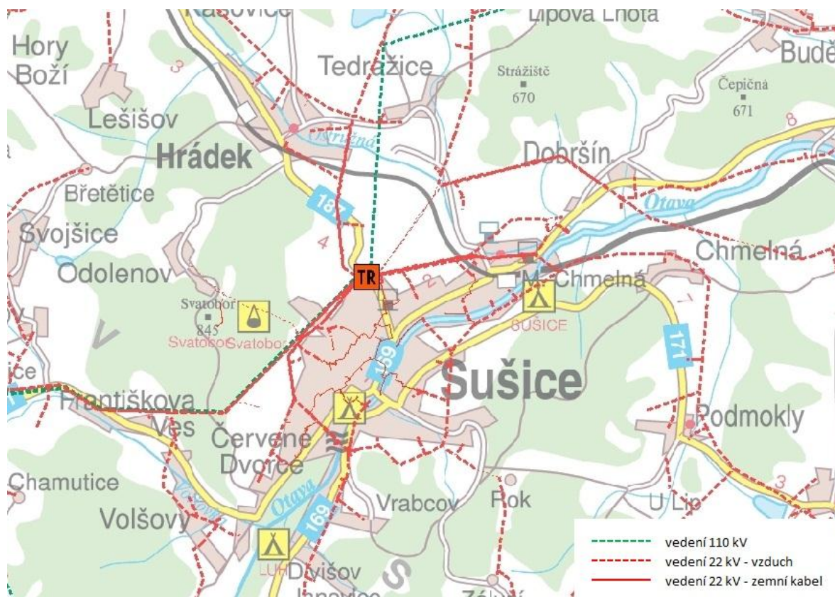
Obr. č. 1 – Transformovna Sušice, vedení 22kV a 110kV [5]
