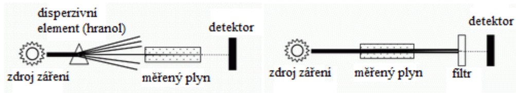
Obr. 25: DIR, NDIR spektrometrický senzor, princip [37]
