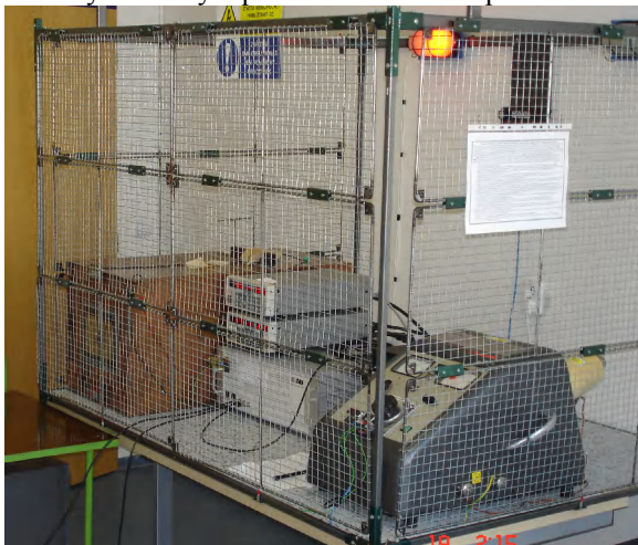
Obr. 3: Pracoviště pro vysokonapětové a vysokofrekvenční pulzní namáhání vzorků izolačních materiálů.
