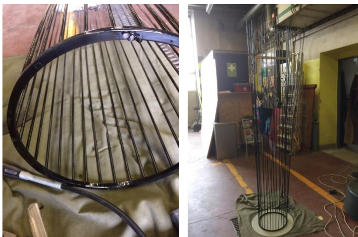
Obr. 13 - Oprava závitů a odřezání od vrchního kruhu a srovnání délky ocelových kulatin
