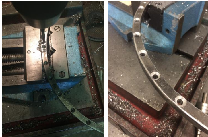
Obr. 9 - Vrtání a hloubení děr ocelových kruhů
