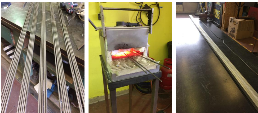
Obr. 10 - Ohřev a ohyb ocelových kulatin
