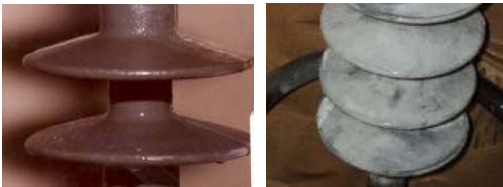
Obr. 2.3 – Izolátor Ohio Brass 511206-1400 (rok 1995 a 2006)
