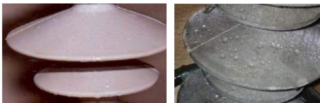
Obr. 2.5 – Izolátor Rebosio E00624 M (rok 1995 a 2006)
