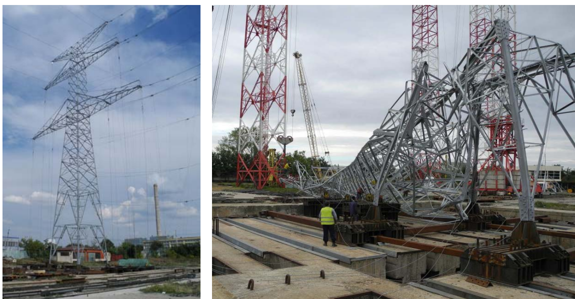
Obr. 1.2 – Stožár Donau 2012 - N+4 – zatěžovací zkoušky v Bukurešti 09/2013 18
