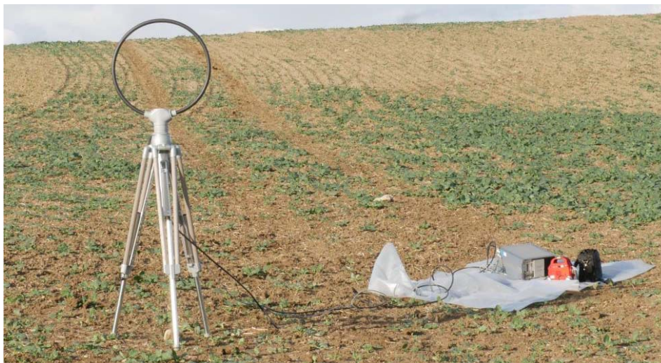
Obr. 3.2 – Měřicí anténa a zkušební přijímač Rohde-Schwarz (viz [47])
