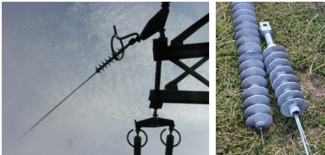
Obr. 2.12 – Přetržený izolátor na V225/6 – stav po 6-ti letech provozu 67
