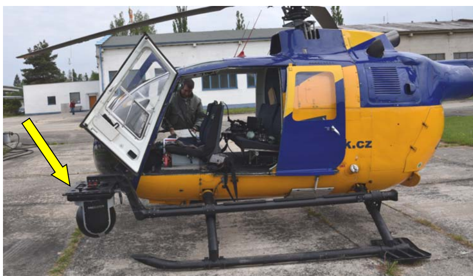
Obr. 3.6 – Instalace plošiny s korónovou kamerou na vrtulníku MBB Bö 105CB 95
