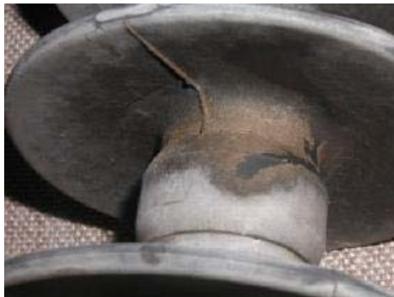
Obr. 2.10 – Lehký únik silikonového oleje z mezivrstvy – stav po 6-ti letech v provozu 65
