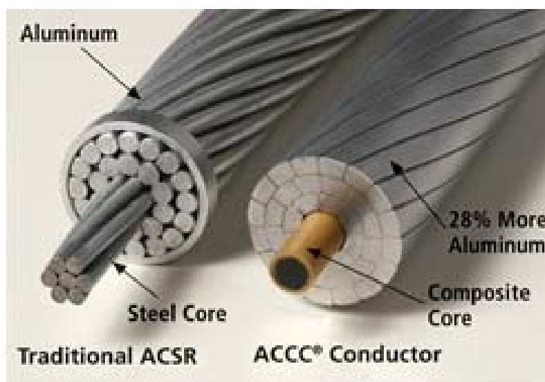
Obr. 1.3 – Srovnání konstrukce tradičního AlFe lana s ACCC (dráty s úpravou TW) při stejném průměru vodiče 30
