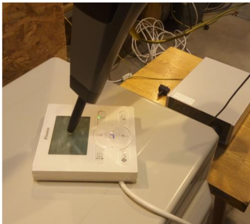
Obrázek 10 Zkouška vzduchovým výbojem
