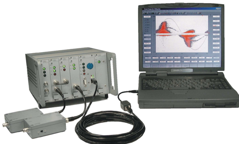
Obr. 14: Digitální detektor částečných výbojů použitý při měření
