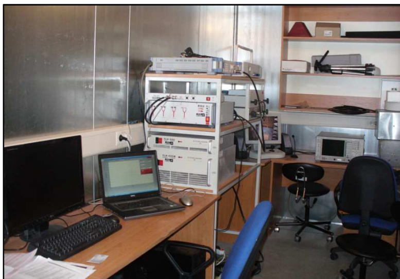
Obr. 3.2 Chráněná ovládací místnost bezodrazové komory na ZČU
