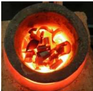
Tavení odštěpků ke stanovení kvality oceli
