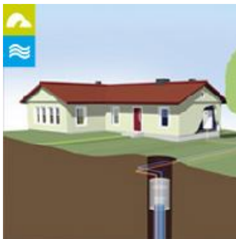
Obr. 21: Tepelné čerpadlo země/voda – vrt [11]
