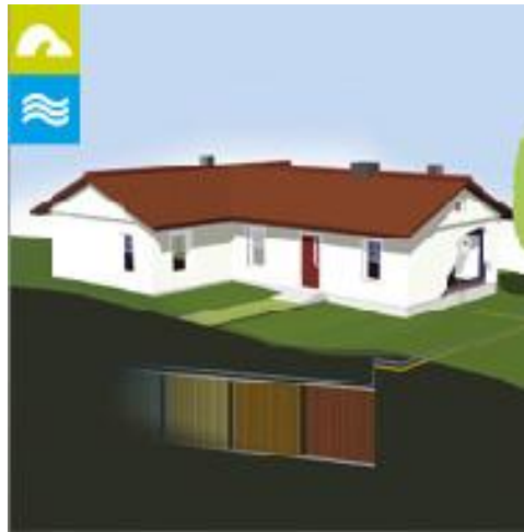
Obr. 22: Tepelné čerpadlo země/voda – větrací vzduch [11]
