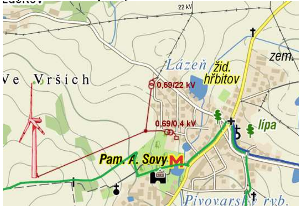
Obr. 26 Vyvedení výkonu z větrné turbíny do objektu ZŠ a do distribuční sítě 22kV
