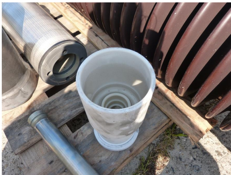
Obr. 2.13 Pohled na teflonovou trysku vypínače
