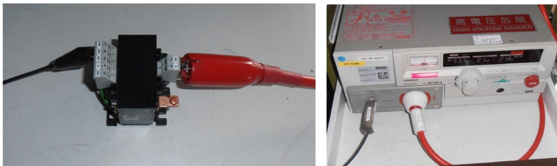
Obr. 4.34: a) Připojení zkoušeného vzorku b) Testovací přístroj Kikusui
