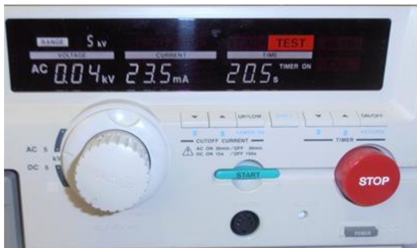
Obr. 4.5: Displej měřícího přístroje po průrazu izolace
