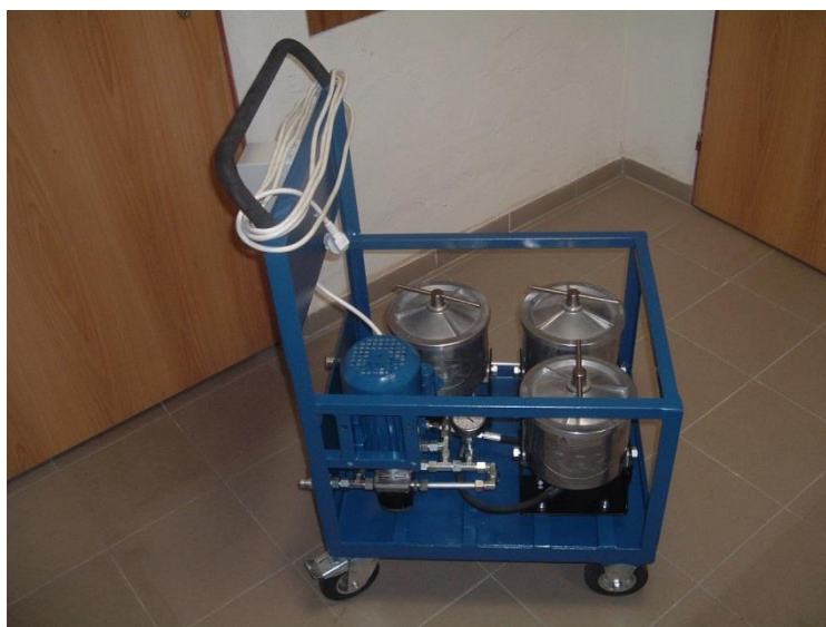
Obr. 1.3: Mobilní zařízení na filtraci použitého oleje. [23]
