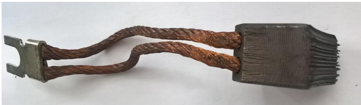
Obr. 2.5 Demontovaný uhlíkový kartáč z poškozené kroužkové hlavy motoru
