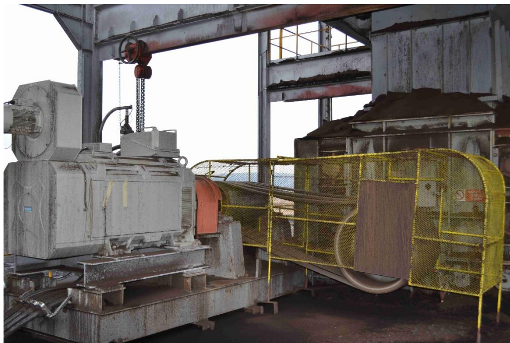
Obr. 2.6 Nízkonapět'ový motor SIMOTICS typ 1LQ1322-4BC53-3AA2
