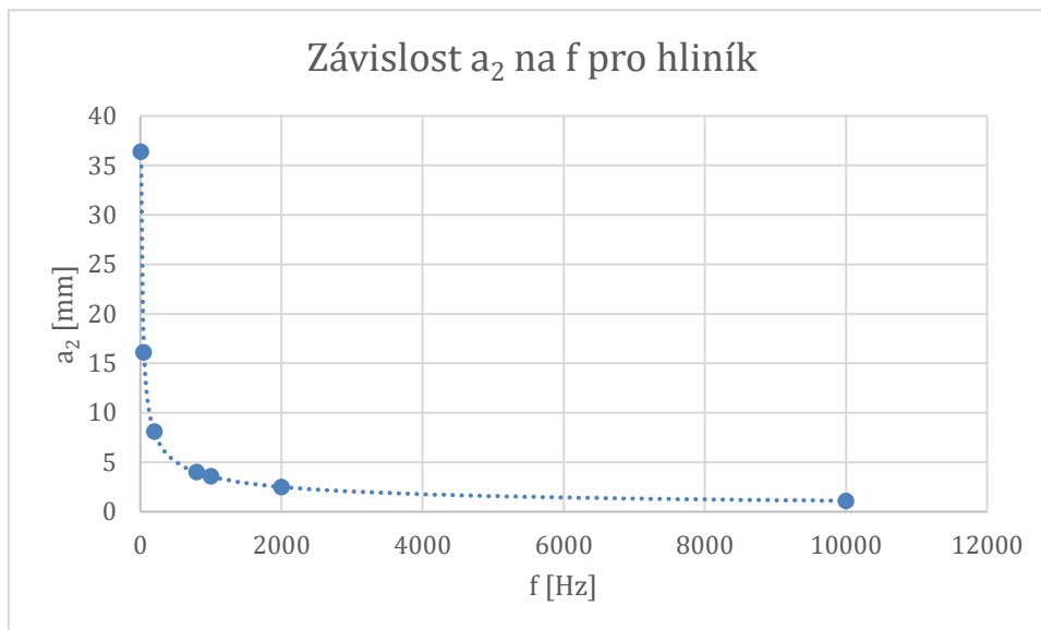
Obr. 16: Závislost hloubky vniku na pracovní frekvenci do hliníkové vsázky
