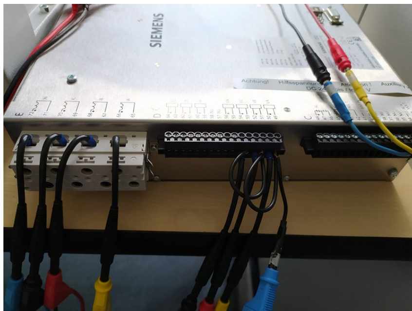
Obrázek 5.6: Zapojení I/U analogových vstupů MU
