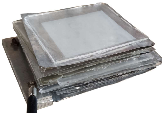
Obrázek 16: Uzemněné vzorky z důvodu vybití elektrostatického napětí
