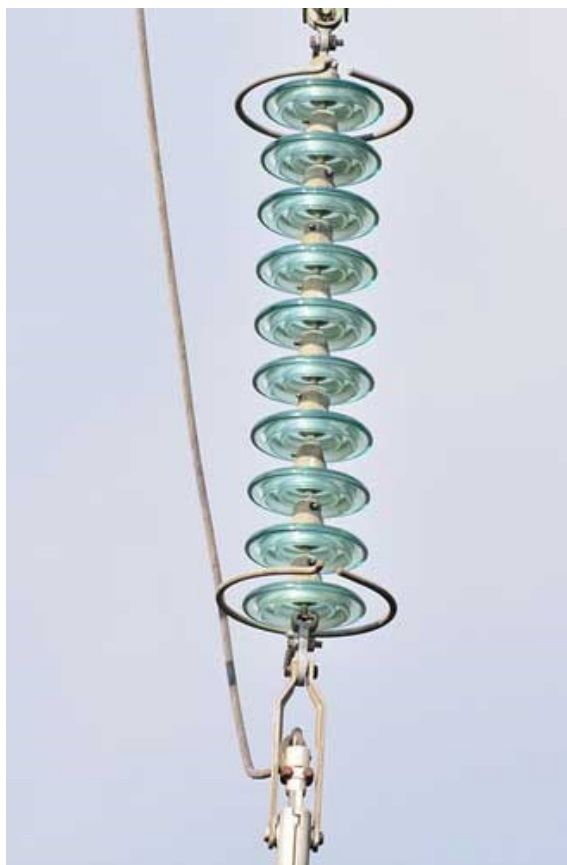
Obr. 1.9: Skleněný talířový izolátor – převzato [23]
