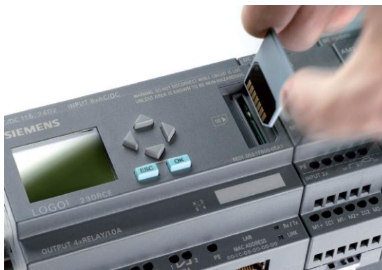
Obr. 3.3 Základní jednotka Logo! 0BA7 typu 230 RCE s kartou SD, přejato z [9]
