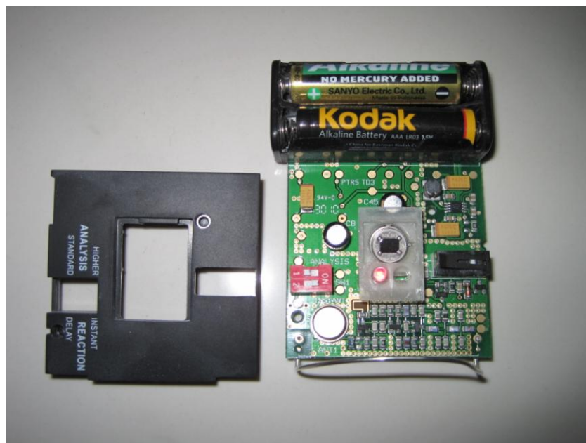
Obr. 4.11 Osazení vnitřních součástek bezdrátového PIR detektoru
