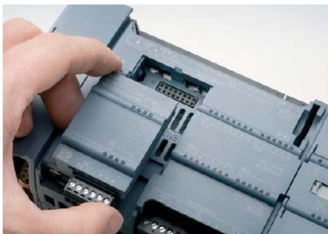
Obr. 3.4 Ukázka zapojení signální desky ( signal board ), přejato z [9]
