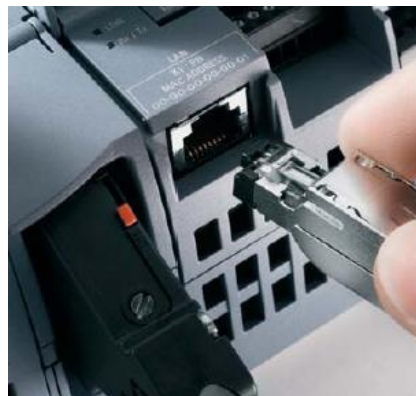
Obr. 3.5 Integrované rozhraní Profinet, přejato z [9]
