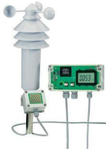
Obr. 4.8 Meteorologická stanice pro snímání světla, deště a větru
