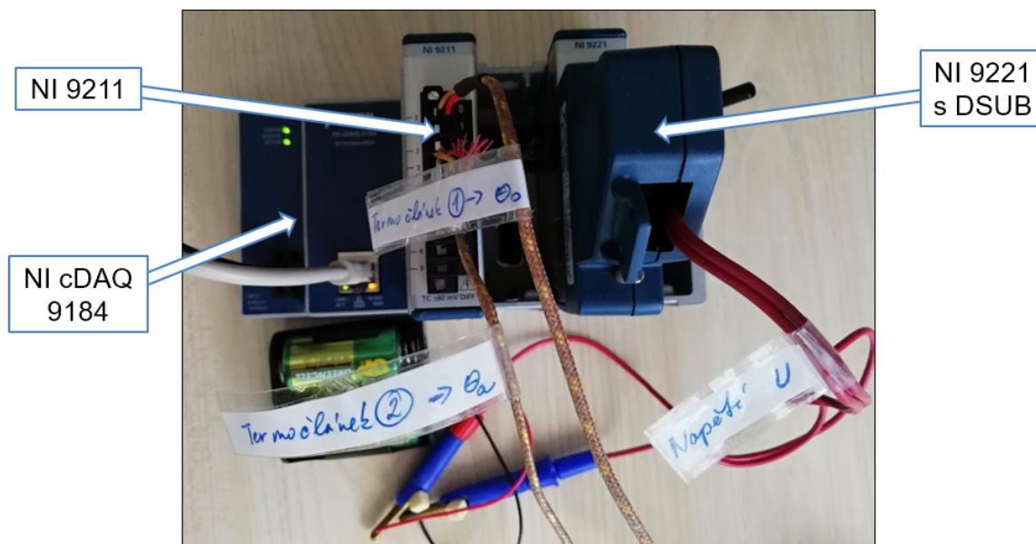
Obrázek 3.9: Zapojení měřicích modulů během funkční zkoušky.
