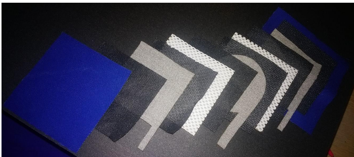
Obr. 3.3: Struktura navrženého senzoru s kruhovou vnitřní elektrodou – TYP 6.
