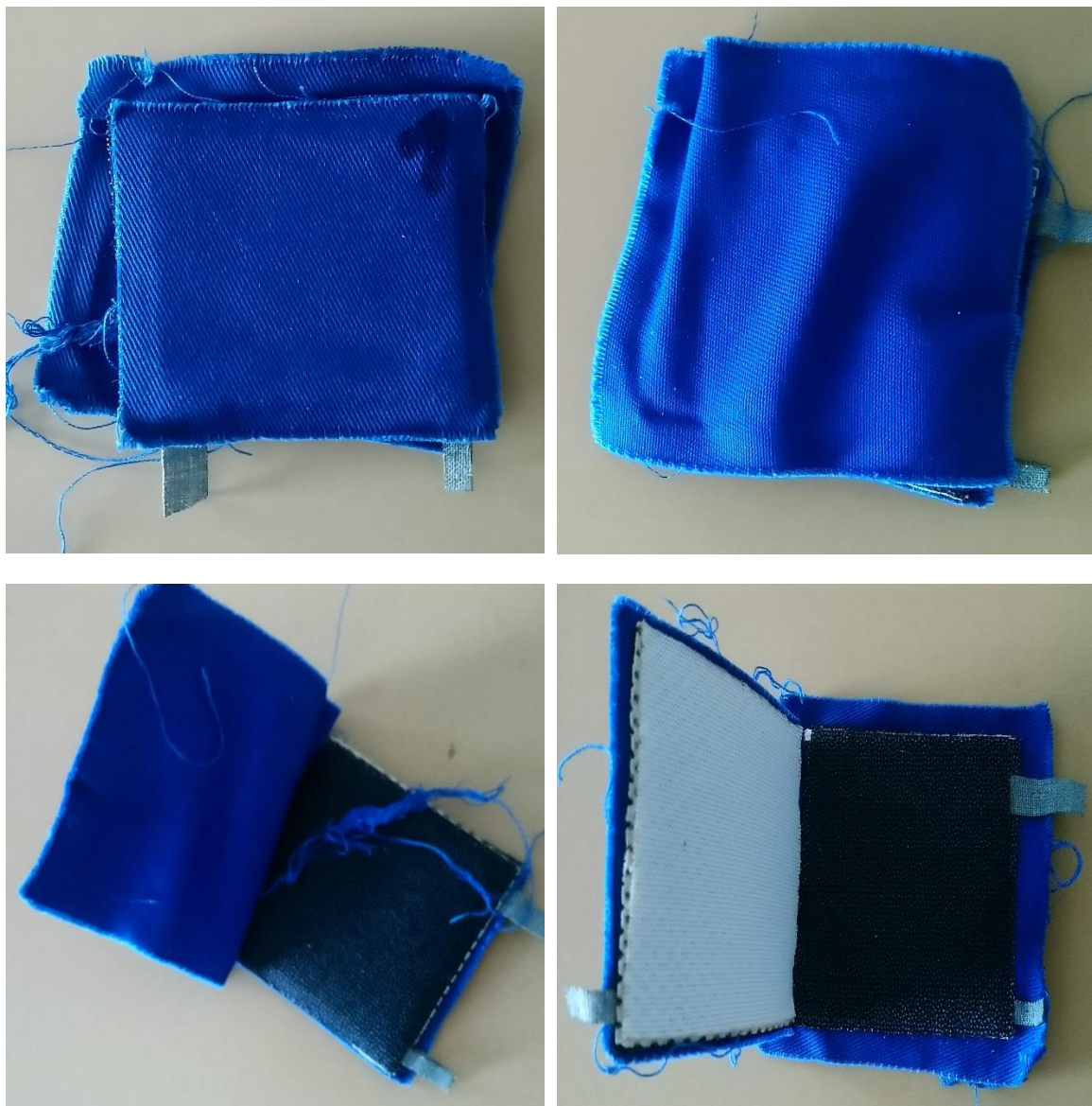
Obr. 4.18: TYP 6 – Poškození senzorů po první práci sérii.
