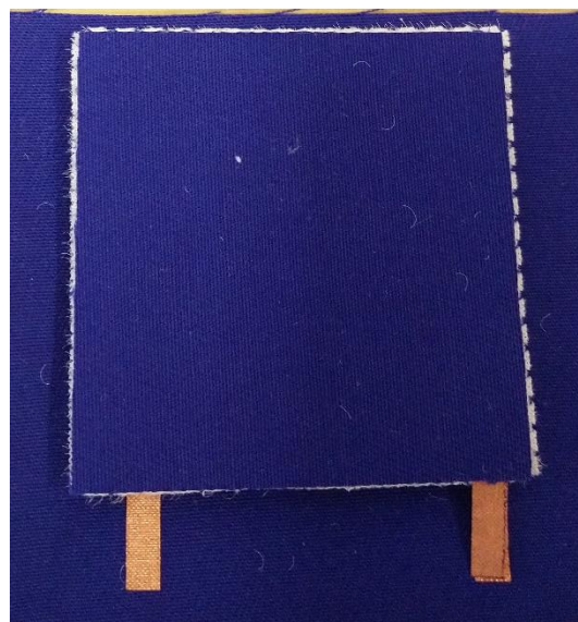
Obr. 3.10: Tlakový kapacitní senzor před dokončením (vlevo), dokončený (pravo).
