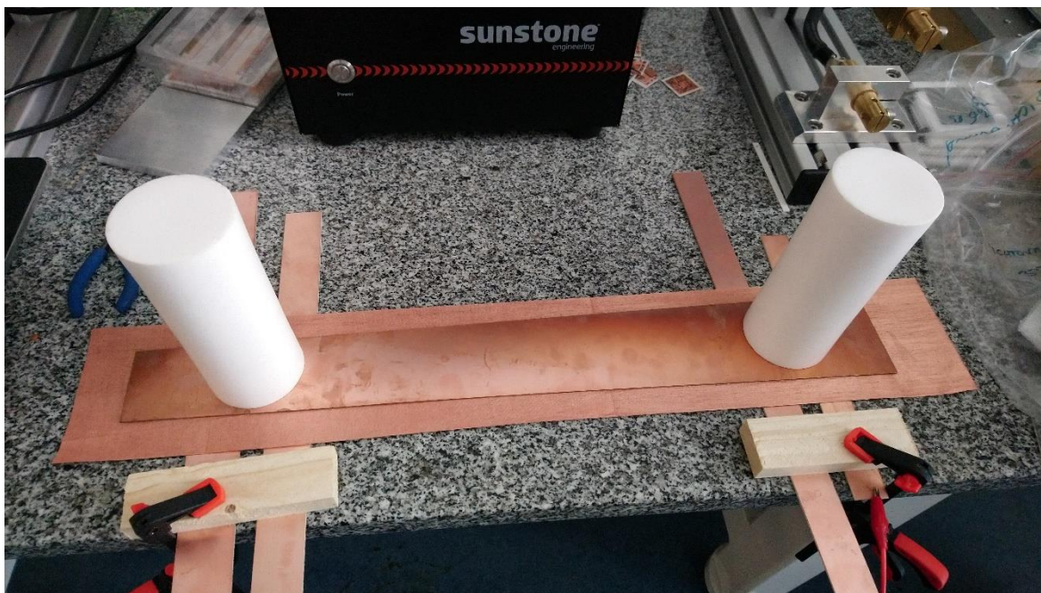
Obr. 4.8: Ukázka měření vodivých stuh napěťovo-proudovou metodou.
