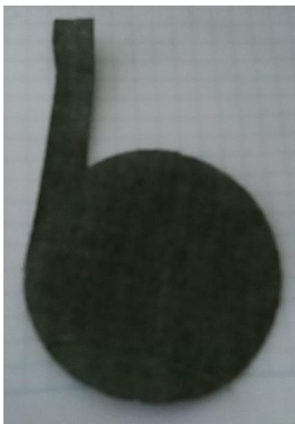
Obr. 4.11: Kruhová vnitřní vodivá textilie vyříznutá laserem.
