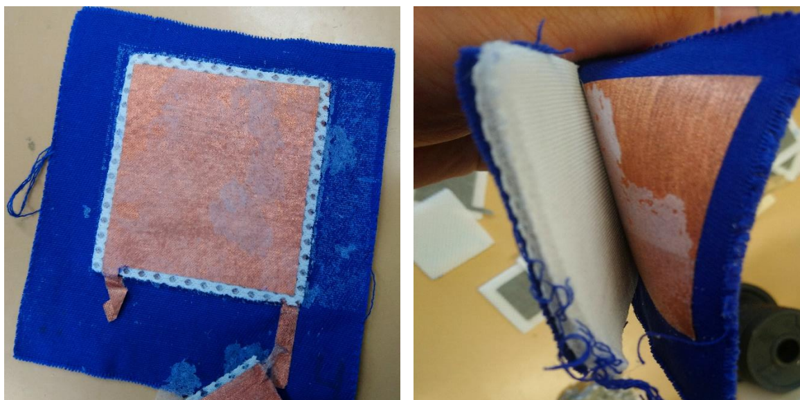
Obr. 4.17: TYP 5 – Poškození senzoru č. 4 po prvním pracím cyklu.
