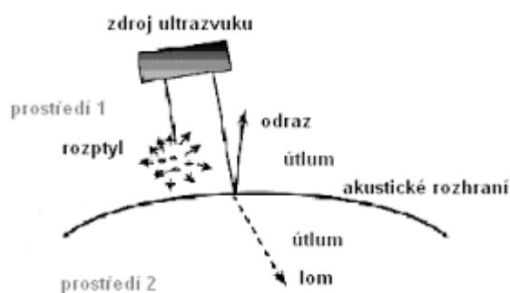
Obrázek 1 Schéma fyzikálních jevů při dopadu vlnění na rozhraní dvou impedančních prostředí
