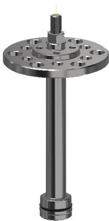
Obrázek 11 – Varianta 2 – Sestava přípravků pro nátrubky VVER 1000
