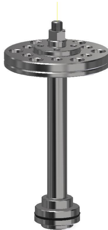
Obrázek 12 – Varianta 2 – Sestava přípravků pro nátrubky VVER 440
