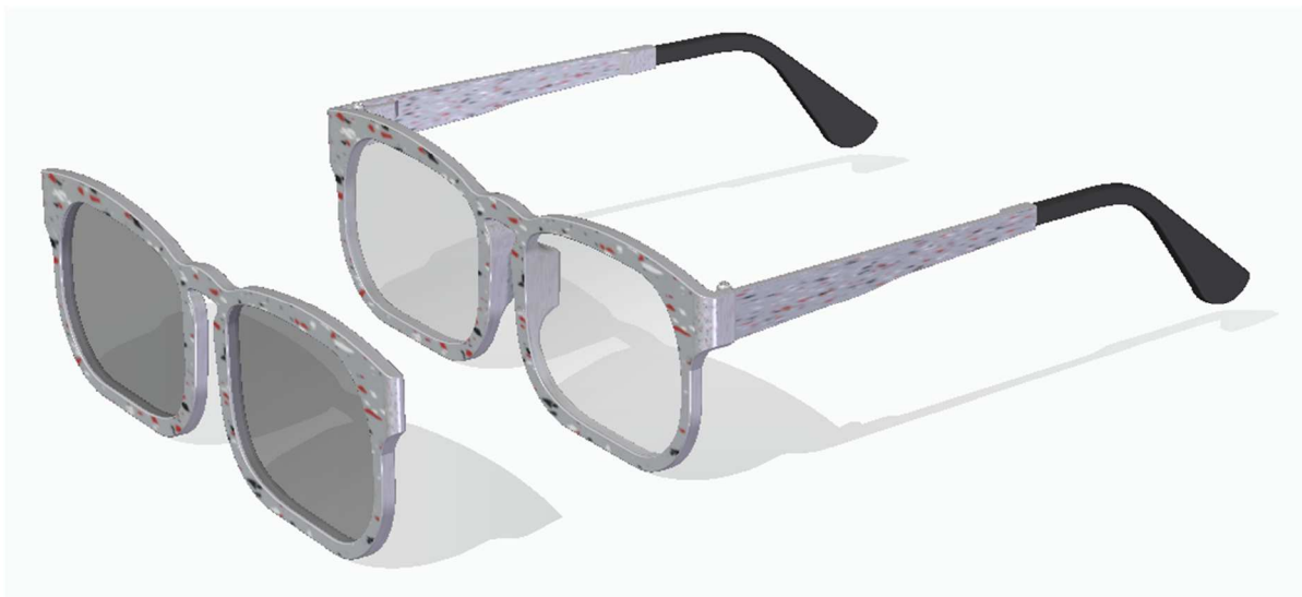
obr. 19 – Brýle z epoxidové pryskyřice (vlastní tvorba v syst. Solid Edge 2019)
